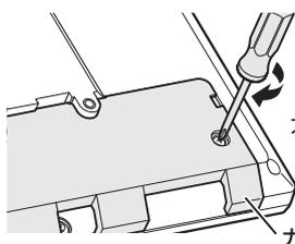
カバーを取り付けて、(2)で緩めたネジを締めて固定します。
