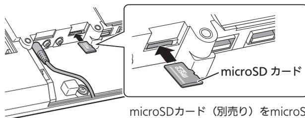
microSDカード (別売り) をmicroSDカード用ソケットにロックするまで挿入します。
