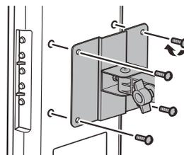
防犯モニター「**ミテマスmini**」や「**ミテマスPro**」本体の向きを縦または横のいずれかに決めます。防犯モニターの裏面に取付金具を当て、付属のトラス小ネジ(M4x10mm)で4カ所すべてしっかりと締めて固定します。
