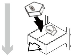
収納する部品のトレイが自動的に解錠され青く光ります。部品を収納します。
