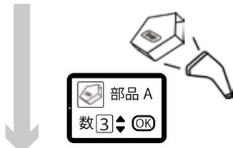
収納する部品のバーコードを読みとり、タブレット画面で数量を入力します。
