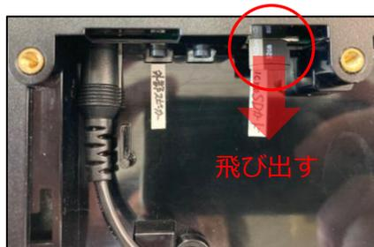
③microSDカードスロットに差さっているmicroSDカードをカチッと音がするまで押し込むとスロットからmicroカードが飛び出します。
