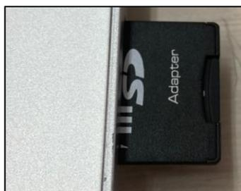
抜き取ったmicroSDカードをカードアダプターなどに入れてPCに差します。
