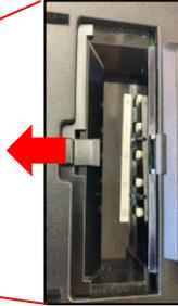
本体背面の左側にある保護カバー部を左にスライドさせると中に5つのボタンがあるので、その中の「▽」と「◎」を同時に長押しします。
