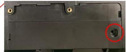
背面下部のカバーを開ける際は赤丸のネジをプラスドライバーで緩めます。
